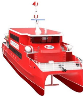
Hình 2. Tàu 2 thân Catamaran lắp thêm cánh ngầm
